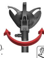
**Отклонение монтажно-демонтажного инструмента и перемещение вдоль каретки, осуществляется с мобильной стойки, автоматически.**
