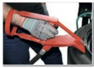
Устройство для взрывной накачки бескамерных шин (опция).
