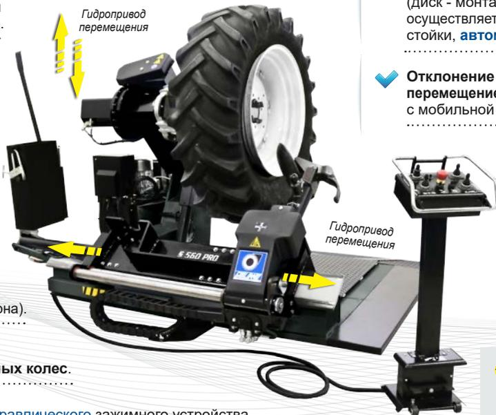
Электрогидравлический блок управления с функцией "stand-by" для снижения энергопотребления.
