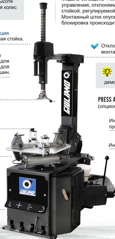
Модель оснащена 4-мя педалями управления, отклоняемой монтажной стойкой, регулируемой монтажной консолью. Монтажный шток опускается вниз вручную, блокировка происходит с помощью кнопки.
