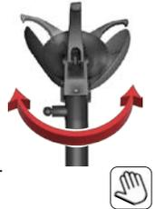
Отклонение монтажно-демонтажного инструмента и перемещение вдоль каретки, осуществляется вручную.
