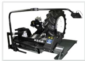
Возможность установки консоли управления на поворотном рычаге (опционально).
