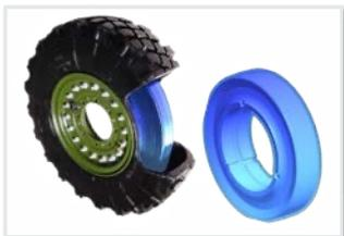
**Стандартная комплектация позволяет быстро и без усилий производить демонтаж / монтаж **твердого кольца** на ободу внутри военных и бронированных шин.**
