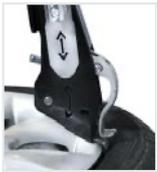
**Запатентованное** монтажно-демонтажное устройство **QX Leverless** для обычных, низкопрофильных и Run Flat шин (доступно в качестве опции).
