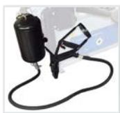
Устройство для взрывной накачки бескамерных шин (опция).
