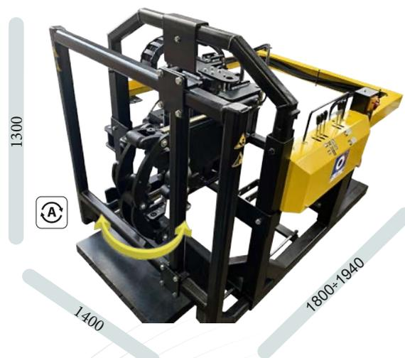
**Монтажно-демонтажный инструмент с автоматическим вращением, сжатием и расширением.**
