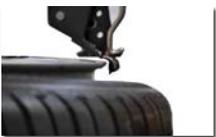
После блокировки монтажная головка **автоматически** перемещается вверх и назад на правильное расстояние от обода (около 2 мм).
