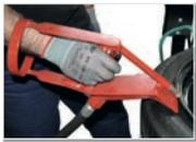
Устройство для взрывной накачки бескамерных шин (доступно в качестве опции).
