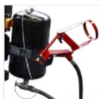
Устройство для взрывной накачки бескамерных шин (опция).
