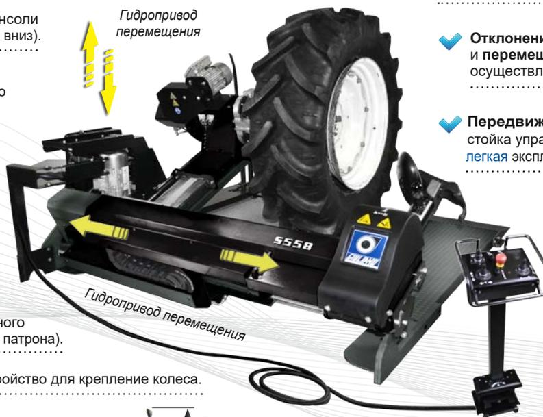
Электрогидравлический блок управления с функцией "stand-by" для снижения энергопотребления.
