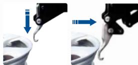
✓ **Бесконтактный** демонтажный инструмент **XTOOL [патент Giuliano]** работает автоматически без прикосновения к ободу. Верхний и нижний инструмент **Touchless** также предназначены для монтажа бортов шин **без риска!!**
