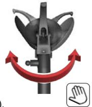
✓ Отклонение монтажно-демонтажного инструмента и перемещение вдоль каретки, осуществляется **вручную.**
