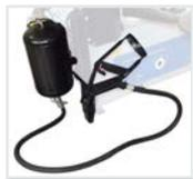
Устройство для взрывной накачки бескамерных шин (опция).
