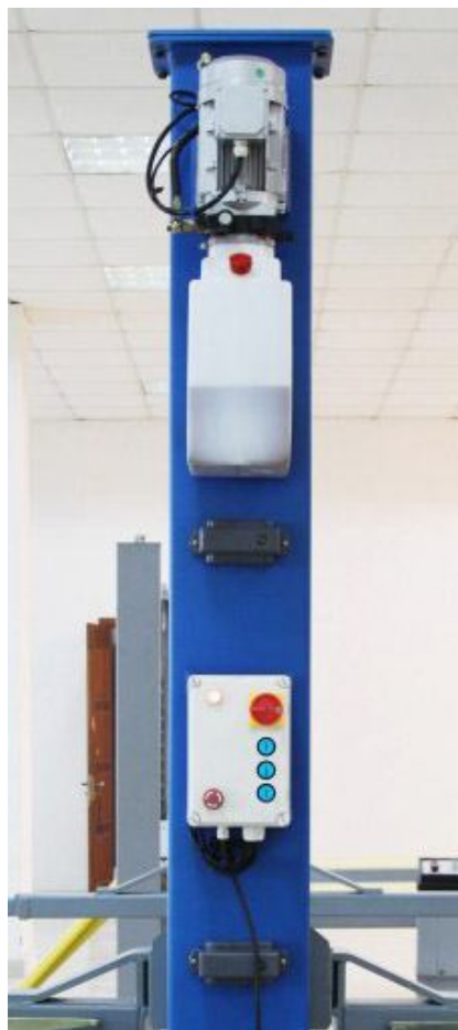
Рис. 2.2 – Установка гидростанции и блока управления
